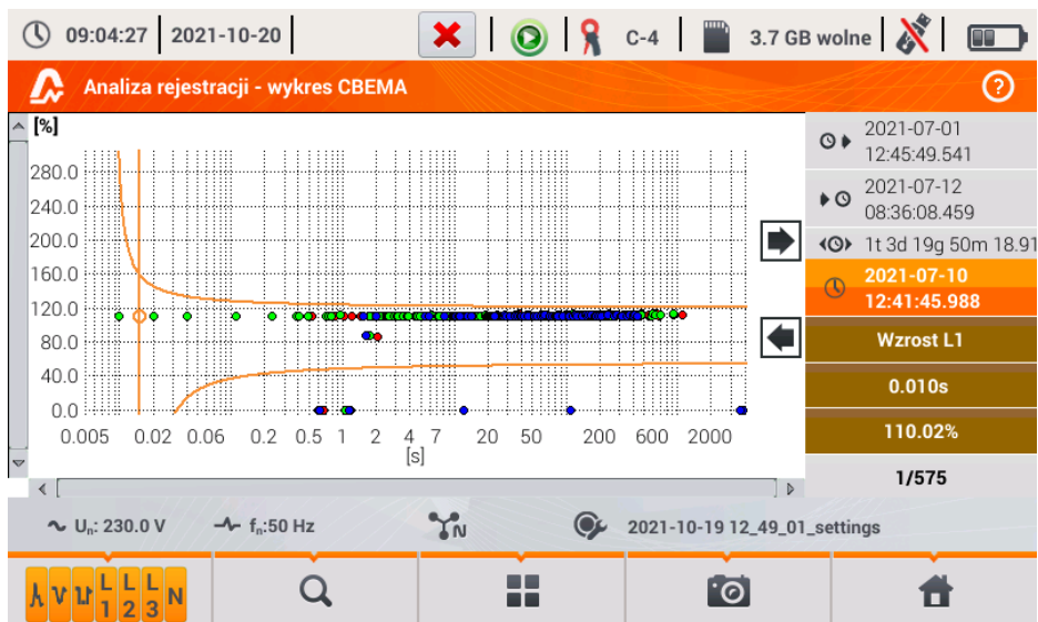
Rys. 32. Analiza rejestracji - wykres CBEMA.
