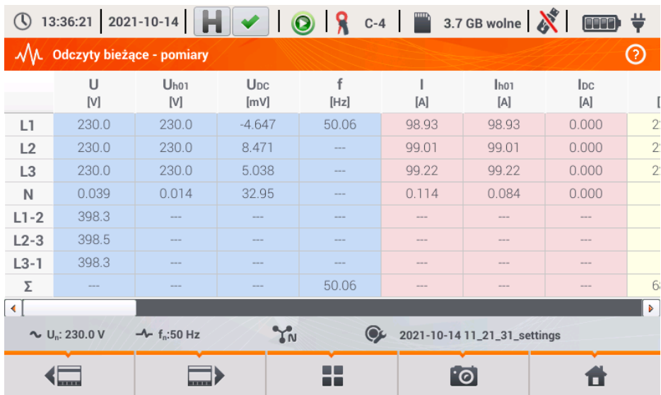
Rys. 54. Odczyty bieżące - pomiary.
