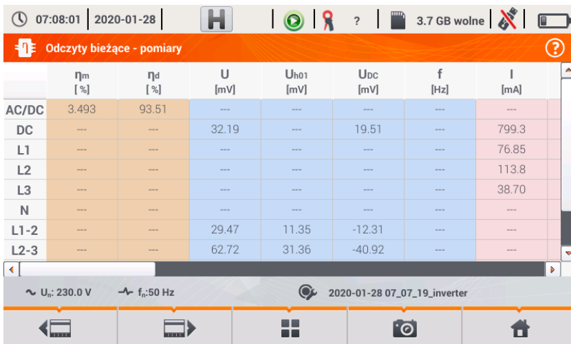
Rys. 47. Odczyty bieżące w widoku tabelarycznym w trybie pomiaru sprawności inwertera.
