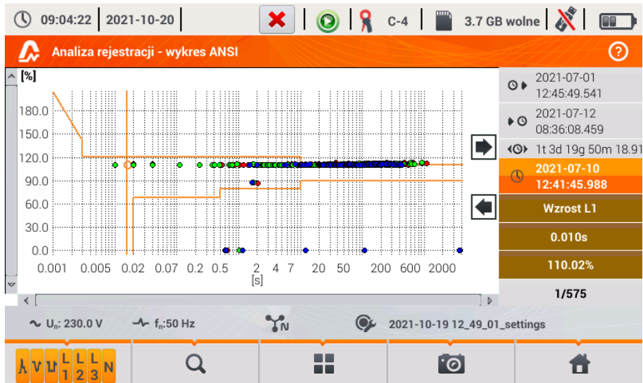
Rys. 31. Analiza rejestracji - wykres ANSI.
